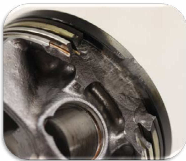
تخریب شدید پیستون در اثر LSPI
