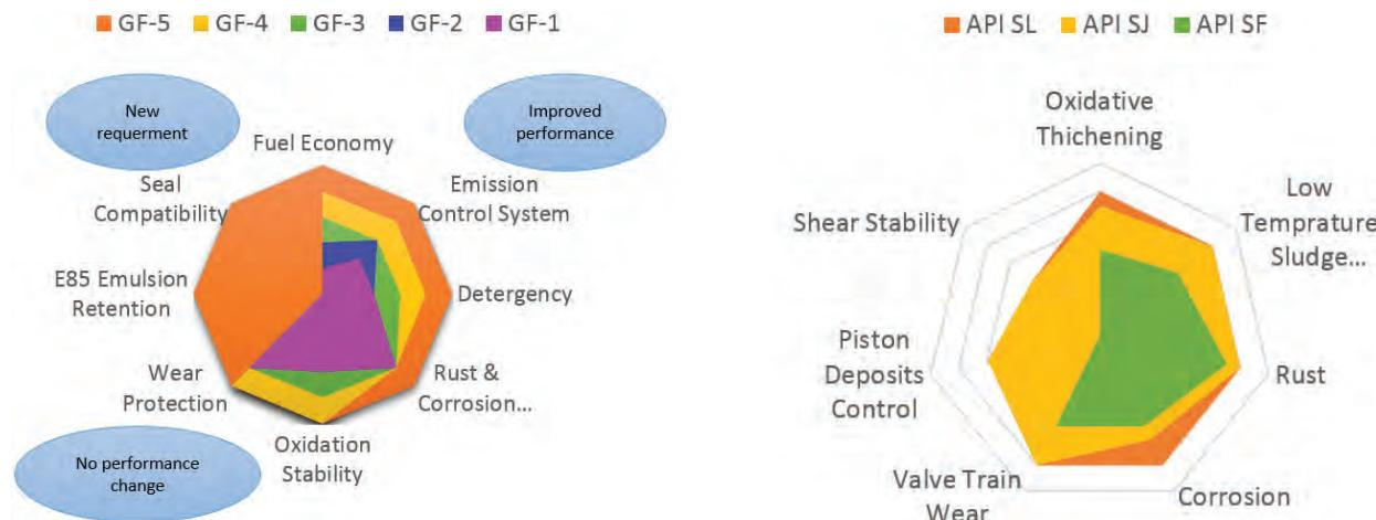
شکل ۱- شروط سختگیرانه‌تر در برابر خوردگی با افزایش سطح کارایی روغن موتور
