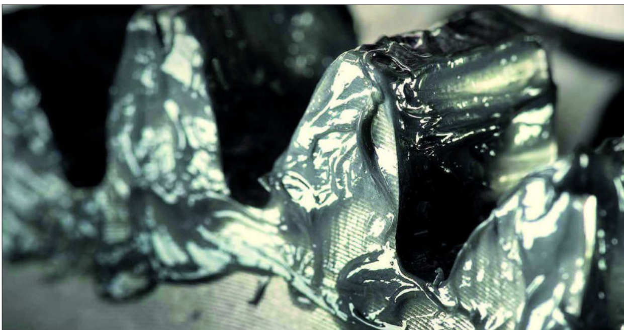
گریس گرافیت دار در دنده های ماشین آلات سنگین که تحت فشارکاری بالا قرار دارند مورد استفاده قرار می گیرد.
