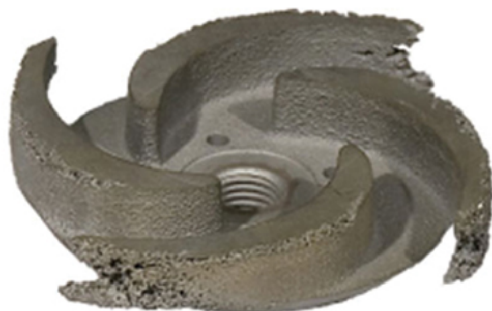
شکل ۱: صدمه ناشی از کف‌زایی روانکار بر قطعه‌هایی از یک توربین
